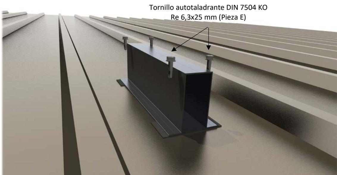
Sobre el perfil P36A se colocarán los paneles fotovoltaicos, compartiendo dicho perfil entre dos módulos. Se fijarán los paneles a los perfiles P36A (Pieza A) por sus extremos mediante grapas de fijación final (Pieza C) e intermedia (Pieza B) con tornillería autotaladrante DIN 7504 KO 6,3x75 mm.
