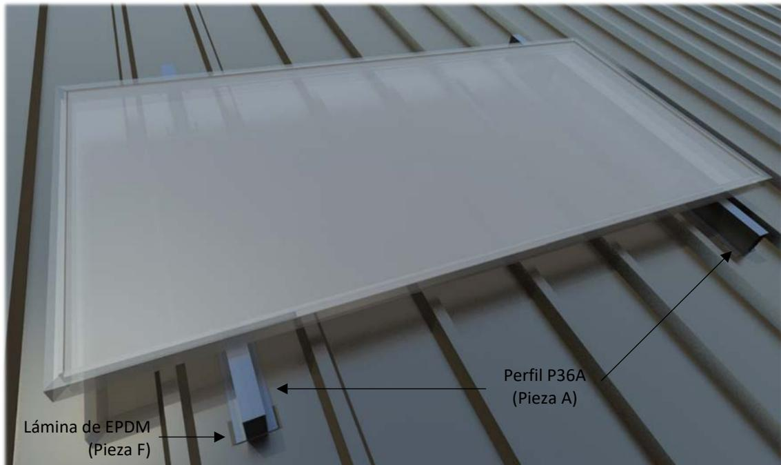
Posteriormente, se fijarán los perfiles P36A mediante tornillería DIN 7504 KO Re 6,3x25 mm autotaladrante (Pieza E) a los valles de la cubierta grecada o panel sándwich.
